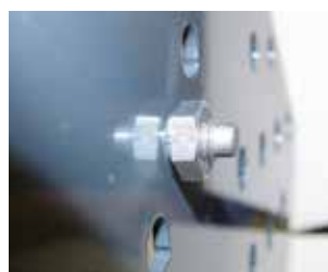
Nakrętka wciśnięta na trzpień gwintowany z niewielką siłą jest wkręcana automatycznie.
