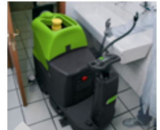
Zbiornik na wodę czystą z węzłem do szybkiego napełniania
