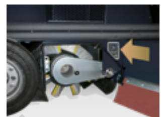
Możliwość wymiany głównego walca zmiatającego bez użycia narzędzi. Ciśnienie i wysokość głównego walca zmiatającego można regulować niezależnie od siebie
