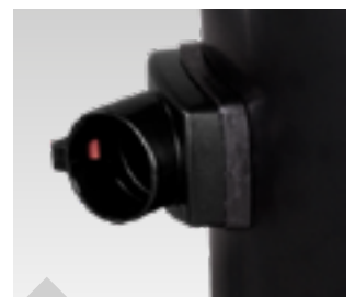
Czyszczenie 3-filtrowe Wlot powietrza jest umieszczony stycznie, aby wesprzeć efekt odśrodkowy (wstępne oddzielenie brudu)
