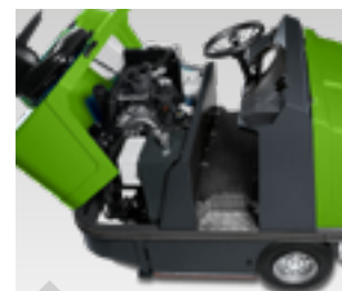
Przy jej projektowaniu pamiętano o zapewnieniu wygodnego dostępu, umożliwiając łatwe i błyskawiczne przeprowadzenie planowych prac konserwacyjnych
