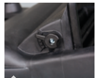
HKM 800: Prosta i bezproblemowa regulacja wysokości walców zmiatających
