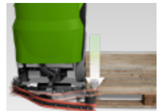
Szczotki czyszczące z automatycznym wsuwaniem w przypadku uderzeń
