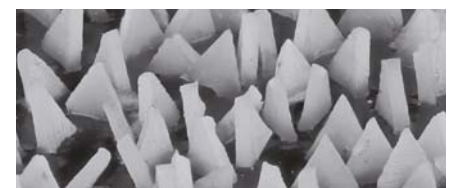
Optymalne ustawienie ziarna ściernego VICTOGRAIN
