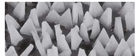
Optymalne ustawienie ziarna ściernego VICTOGRAIN
