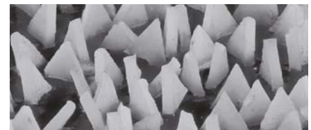
Optymalne ustawienie ziarna ściernego VICTOGRAIN
